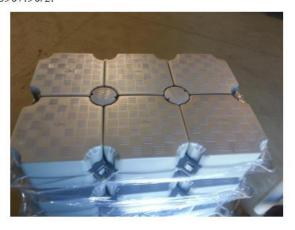
2. Estrutura flutuante consistindo em 134 submontagens, cada submontagem constituída por seis cubos de polietileno de alta densidade (HDPE), cujo interior é guarnecido com poliestireno expandido. As submontagens devem ser interligadas para formar estruturas flutuantes predefinidas maiores, como, por exemplo, docas flutuantes, passarelas flutuantes, plataformas de trabalho flutuantes, marinas, etc.
