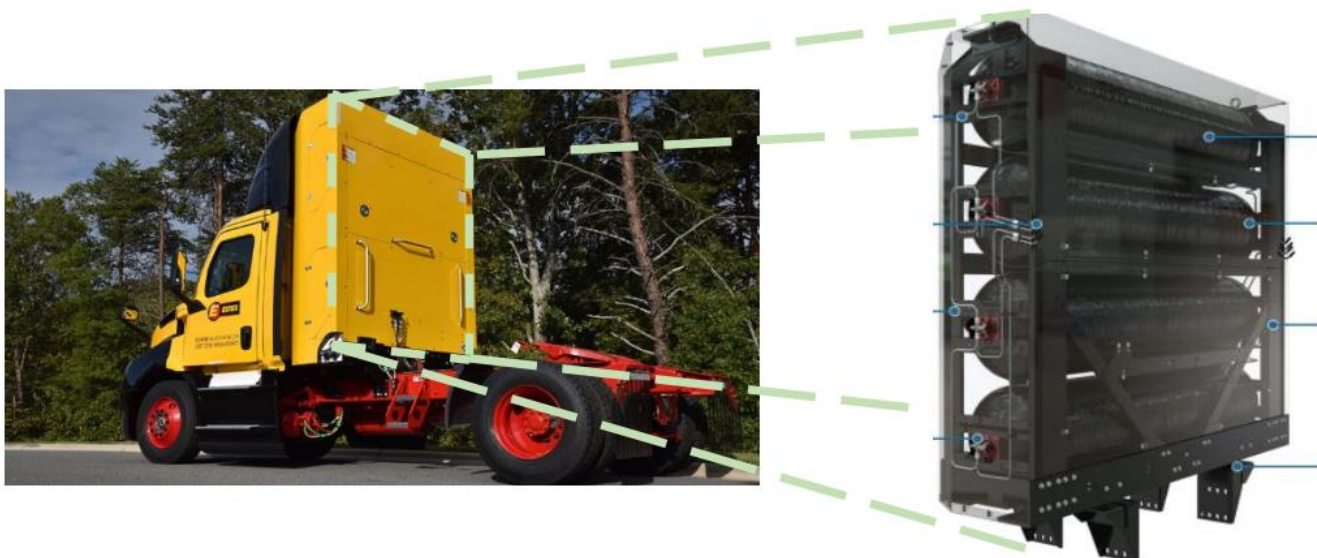
Quatro cilindros instalados atrás de cabine de caminhão, a serem utilizados como combustível
