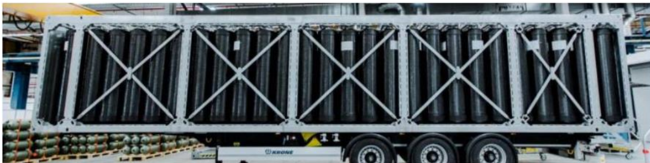
Vários cilindros aplicados em carreta para transporte do gás
