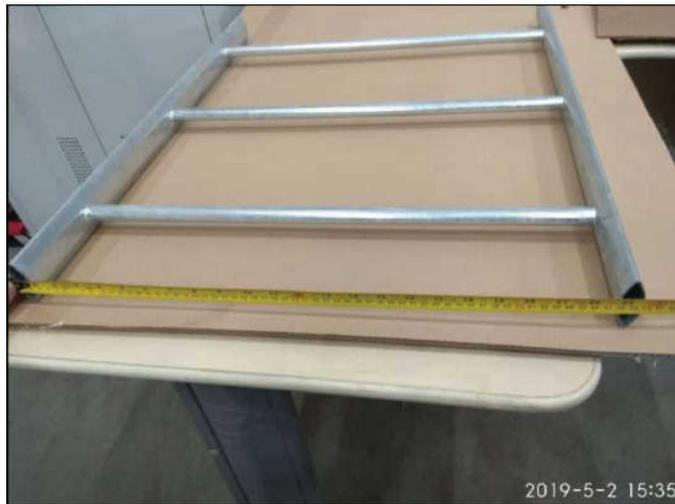
Detalhe do comprimento da peça (750 mm)
