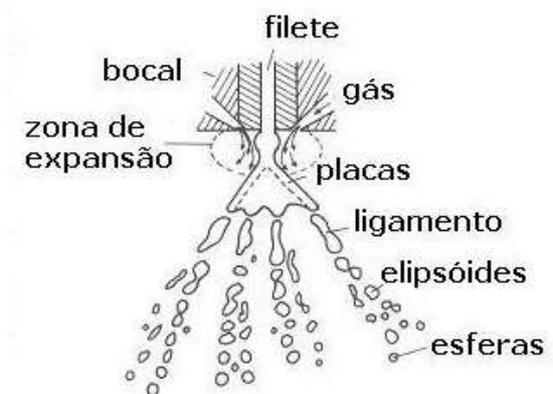
12. O tamanho e a forma das partículas variam em função de vários parâmetros, dentre os quais: a espessura do filete, a pressão do gás, a geometria do conjunto de pulverização. Ainda assim, dentro de um mesmo processo, há de se separar os diâmetros dos pós conforme a exigência de cada industrialização.
