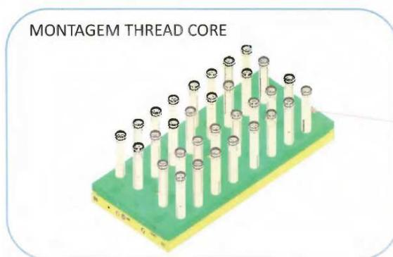
*\*Demonstração da montagem do “Thread Core” no Molde de Injeção.*
