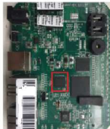
Circuito Integrado Memória Flash montado na placa principal do SAT fiscal
